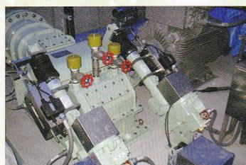
小水力のクロスフロー型水車発電装置
